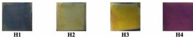
Rys. 4.7.2. Barwne warstwy anodowego tlenku tytanu wytworzone przez elektrochemiczne utlenianie tytanu.
