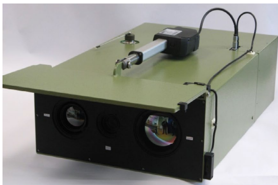
Rys. 1. Zdjęcia zespołu kamer od strony obiektywów kamer (po lewej obiektyw kamery MWIR, w środku kamery VIS, po prawej kamery LWIR) oraz jego wnętrza (bez obudowy)
