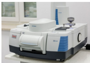
Rys. 1. Spektrometr Nicolet IS-50 Raman/FTIR z długością lasera wzbudzającego 1064 nm i detektorem DLaTGS do mapowania techniką rozproszenia Ramanowskiego. Jednocześnie ze spektrometrem sprzężony jest moduł ATR-IR służący do rejestracji widm w zakresie podczerwieni
