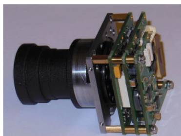
Rys. 2. Zdjęcia kamery o szerokim zakresie natężenia oświetlenia bez obudowy z obiektywem oraz kamery w hermetycznej obudowie dostosowanej do montażu na hełm
