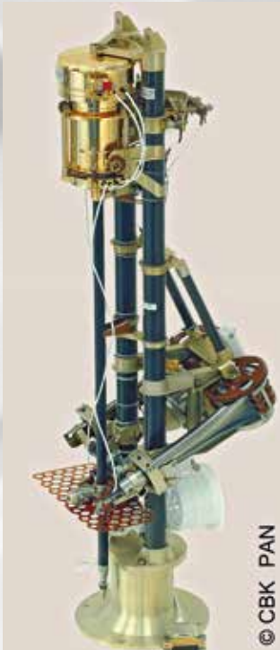
Penetrator MUPUS opracowany w CBK PAN, jedno z kilku najbardziej zaawansowanych technologicznie urządzeń badawczych umieszczonych na pokładzie ładownika misji Rosetta
