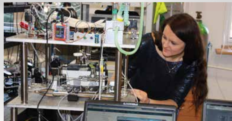
Prace nad układem pobierania próbek oddechu ludzkiego do sensora biomarkerów raka
