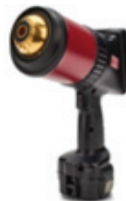
Stanowisko do pomiaru całkowitej reflektancji solarnej, emisyjności względnej i wyznaczania współczynnika reflektancji solarnej (SRI) materiałów stałych
