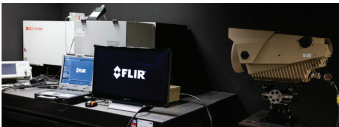
Stanowisko do pomiaru parametrów kamer termowizyjnych
