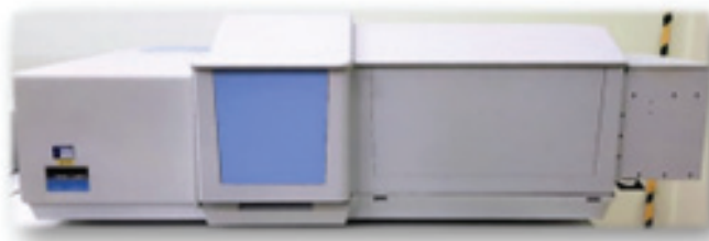
Stanowisko do pomiaru całkowitej reflektancji solarnej, emisyjności względnej i wyznaczania współczynnika reflektancji solarnej (SRI) materiałów stałych
