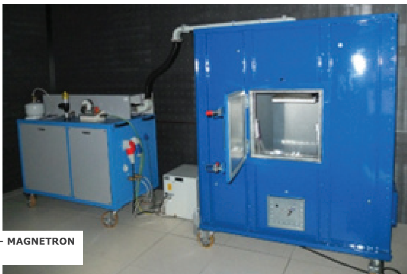
Ultrakompaktowa komora bezodbiciowa (UCC-L) 5105 x 5105 x 3000 mm (tłumienie promieniowania E-M do 120 dB)
