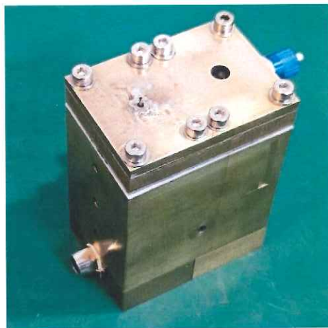
Rysunek 34. Zdjęcie zaworu do wytwarzania tarcz aerolowych w próżni
