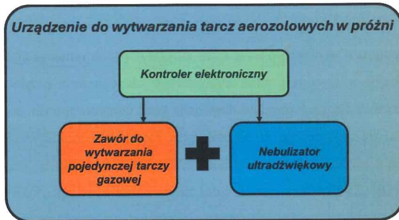
Rysunek 30. Schemat blokowy systemu do wytwarzania tarcz aerozolowych w próżni.
