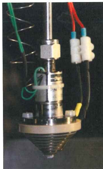
Rysunek 14. System do wytwarzania tarcz aerozolowych metodą termosprejów [91, 92].
