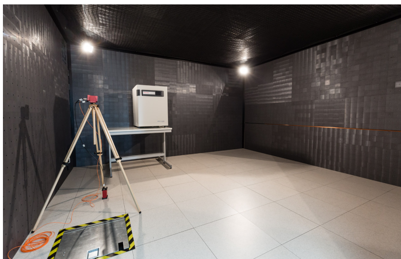
Ultrakompaktowa komora bezodbiciowa (UCC-L) 5105 mm x 5105 mm x 3000 mm (tłumienie promieniowania E-M do 120 dB)
