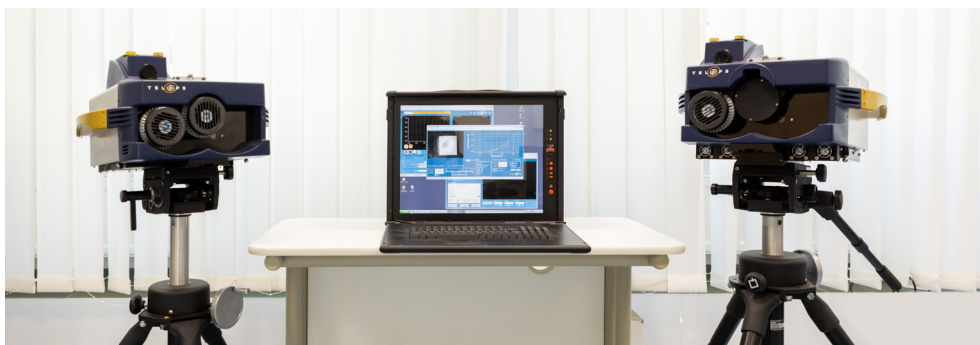
Obrazujące spektrometry Fourierowskie na zakres średniej (MWIR) i dalekiej (LWIR) podczerwieni
