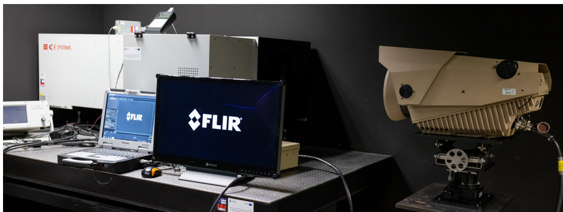
Stanowisko do pomiaru parametrów kamer termowizyjnych
